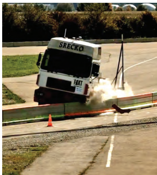
Izvršen je udar vozilom TB 42 (kamion od 10 tona pri 70 km/h i ugao udara od 15°) na „pregradu pametne radne zone“
