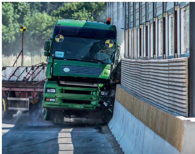
Betonska montažna zaštitna ograda DELTABLOC® DB 150 NBF, nivo zaštite H4b sa integrisanom barijerom protiv buke serije PHONOBLOC®, ukupne visine sistema zvučne barijere i do 6 m.
