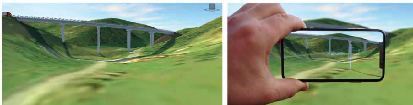
Slika 6. Primer BIM projekta „na terenu“ uz pomoć telefona kroz proširenu realnost na mestu izgradnje
