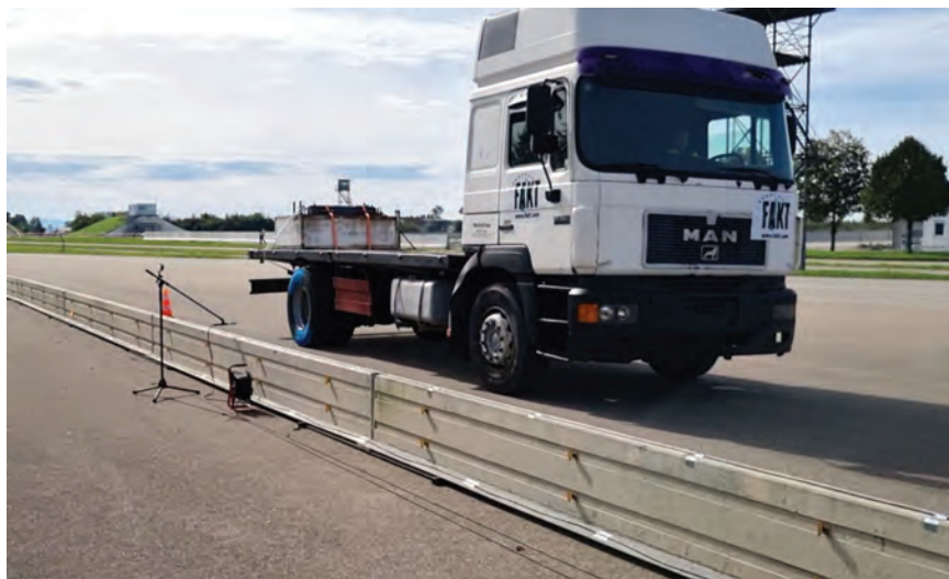
Probno podešavanje sa optičkim kablovima koji su instalirani na zaštitnoj barijeri radne zone i različitim tipovima vozila
